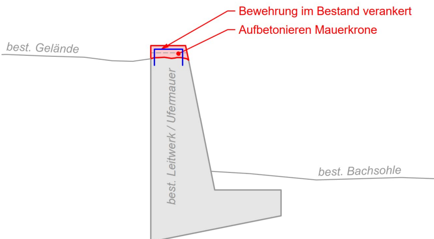
Abbildung 20: Skizze Aufbetonieren Mauerkrone
