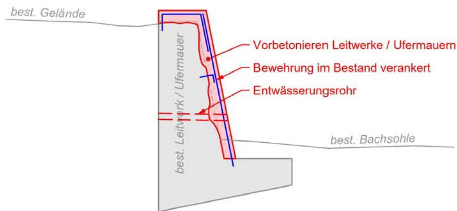
Abbildung 21: Skizze Vorbetonierung Leitwerke / Ufermauern unterhalb Sperre
