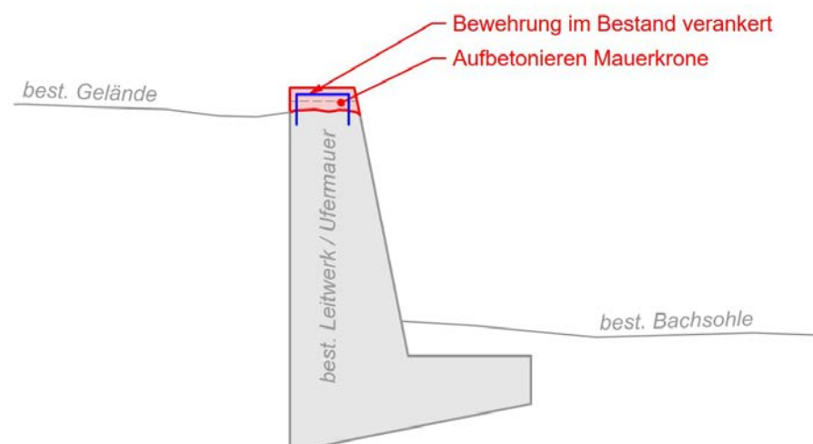
Abbildung 20: Skizze Aufbetonieren Mauerkrone
